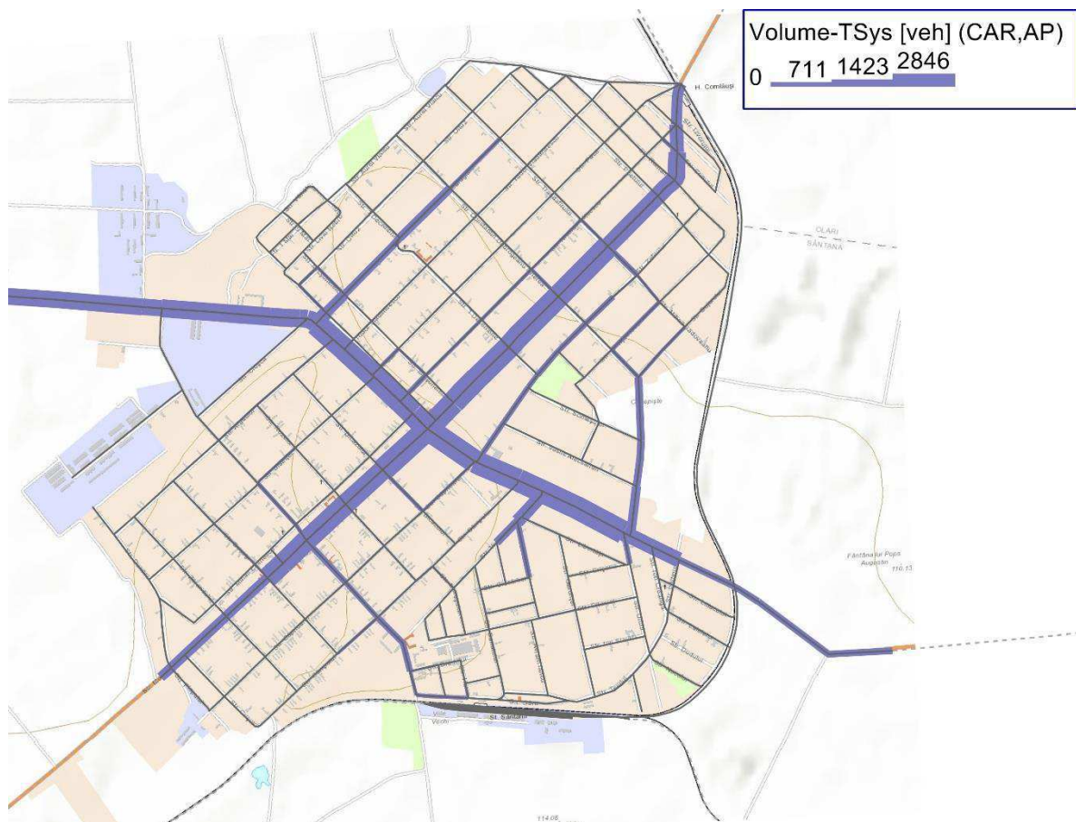
Figura 3.4-1. Afectarea cererii de transport pe rețea - Autoturisme - vehicule/zi -2017
